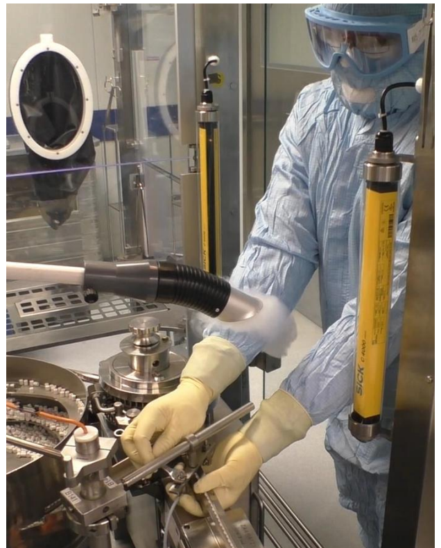
Strömungsvisualisierung beim Personaleingriff an einem RABS
